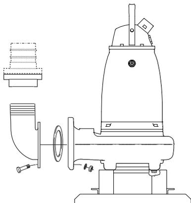
Рис. 3: Установка типа S
