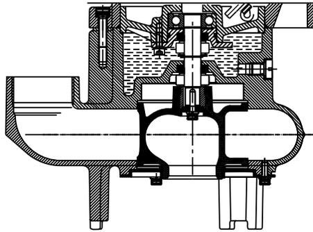
Рис. 6: Рабочее колесо типа С
