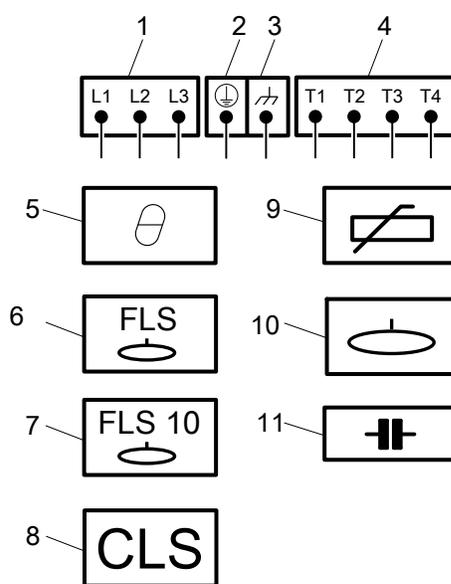
1. Проводники пускового оборудования и питания (L1, L2, L3)
