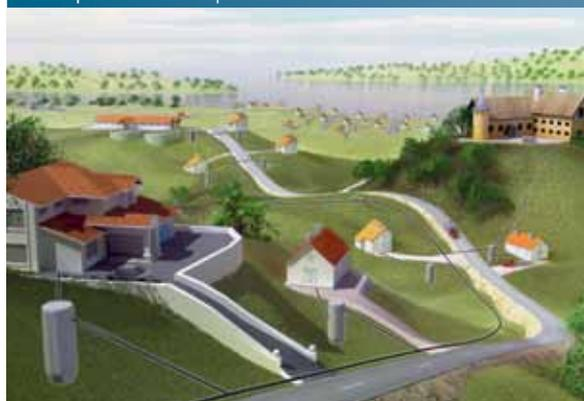
Трубы малого диаметра (50 мм) могут быть проложены на небольшой глубине, что исключает необходимость применения самотечных склонов или дорогостоящих экскаваторных работ. Они могут иметь протяженность до нескольких километров до места врезки в муниципальную канализационную сеть. Специалисты Flygt могут помочь в расчете, проектировании и установке системы.
